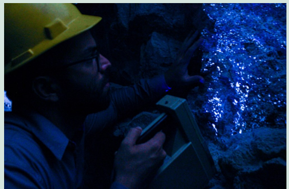
Rochas calcissilicáticas da Formação Jucurutu sob luz ultravioleta, com destaque para cristais fluorescentes de scheelita. Foto Sílas Costa.
