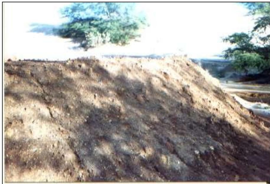
**Figura 78** – Pilha de rejeito da ustulação da pirita e calcopirita
